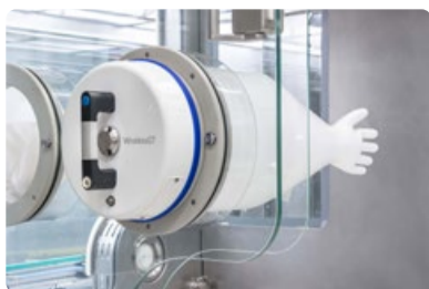
SKAN AG G2.9 Handschuhprüfung als Bestandteil der Anlagensicherheit Glove Test as Part of Plant Safety Täglich 10.00 Uhr
